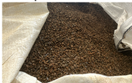
Matière broyée, retraitée pour être réextrudée
