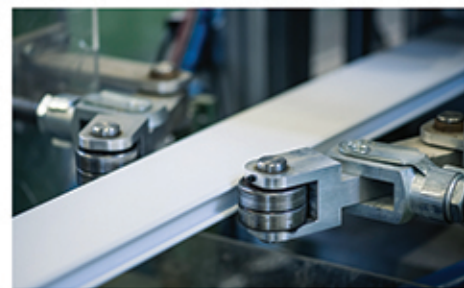
Lame en cours d'extrusion
