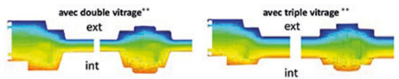
Coefficients de transmission thermique
